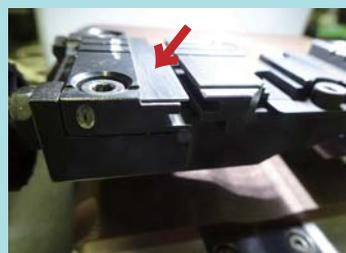
※「MRバイス」は MATRIX SLX/SX の専用交換バイス、「L型バイス治具」「幅広かさ上げ治具」は MATRIX SLX/SX/Pro/Evo の専用治具となっております。
