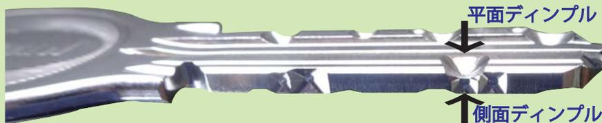
上部画像の↑部のように、平面のディンプルで深さが3番目・4番目の場合で側面ディンプルが同じ位置にある場合は、純正キーでもエントランスや裏口等の共用部シリンダーで鍵が抜けなくなる事例が頻発しています。お客様のお持ちになった鍵がこのパターンの場合には合鍵作製でなく純正キー取寄せで対応してください。
