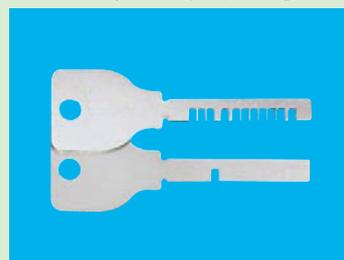
測定治具で測定した位置深さをコードマシンで加工
